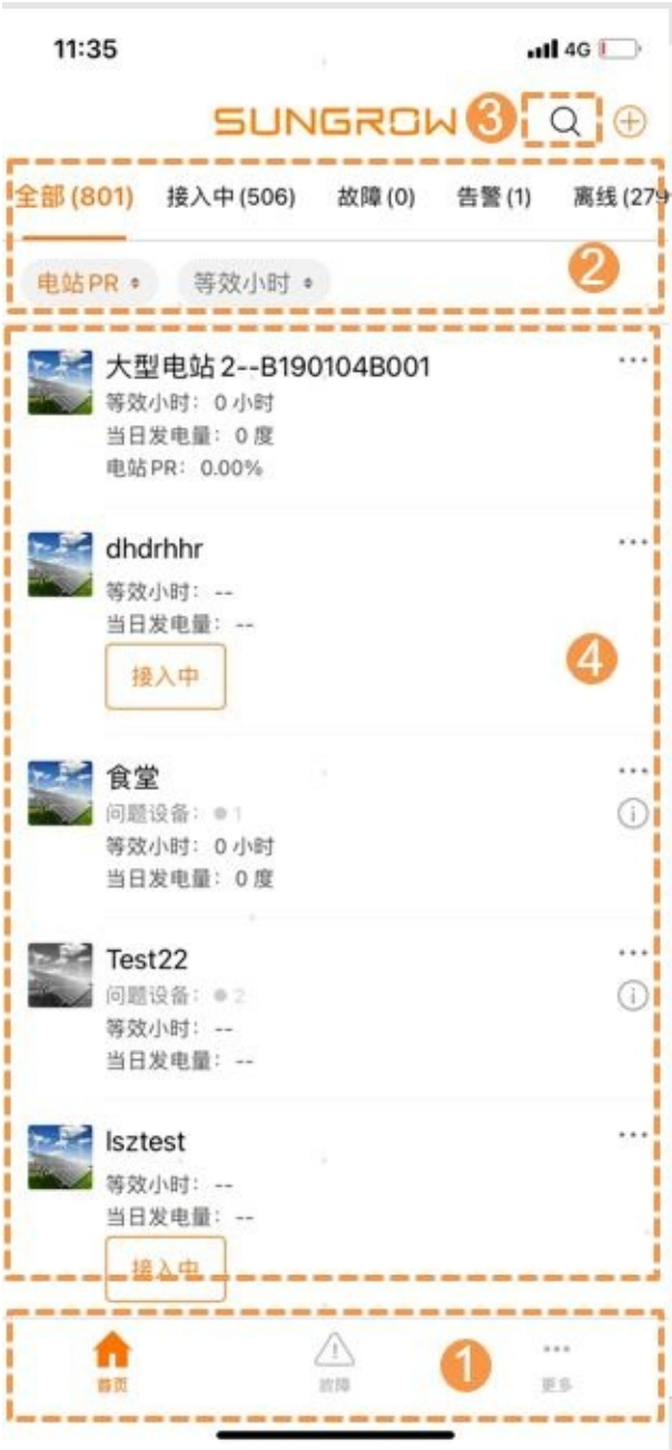
1.导航栏 2.电站状态指标栏 3.搜索栏 4.电站信息列表
